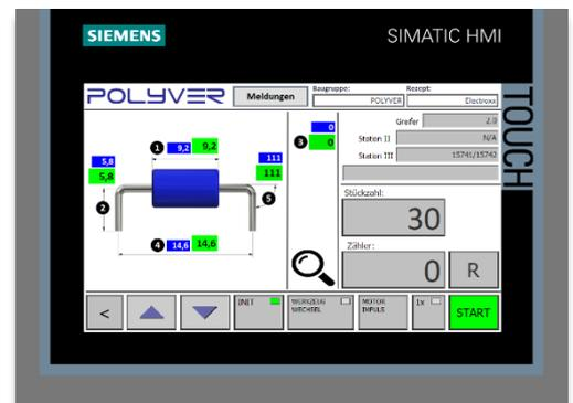
**Einstellgenauigkeit:** Die Einstellgenauigkeit der Achsen beträgt 0,1 mm. Alle Achswerte können in den Datenbanken des SIEMENS-Panels gespeichert werden.
